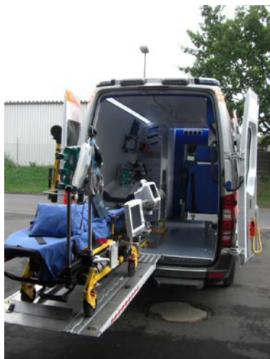
Abbildung 65: Die neue hydraulische Hebebühnentechnologie zur Beladung des Inten- sivtransportsystems am ITW
