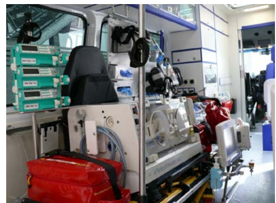
Abbildung 66: Ausrüstung des Intensivtrans- portsystems mit Intensivinkubator zum Trans- port von Früh- und Neugeborenen für den Einsatz als neonatologischer ITW
