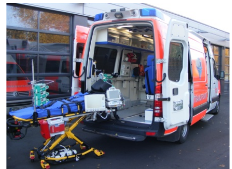
Abbildung 24: ITW der neuen Gene- ration mit Intensivtra- gensystem
