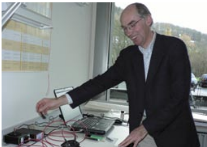
Farbtest. Mittels eines Spektrometers ermittelt Dr. Han Neevel die Farbänderung, die eine Tinte im Verlauf der Restaurierungsbehandlung erfährt.
