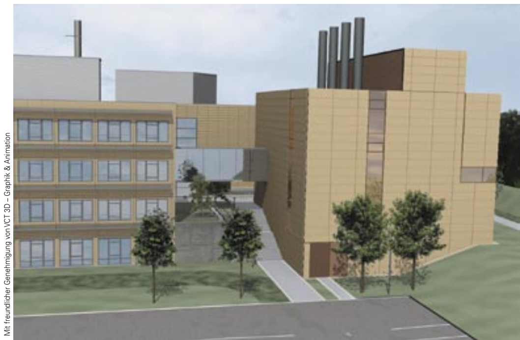
Modell des S4-Labors (rechts im Bild), das durch eine Brücke mit dem Biomedizinischen Forschungszentrum verbunden sein wird. Im mittleren Stockwerk werden die doppelt ausgelegten Labore zu finden sein, darüber und darunter die technischen Räume, wo unter anderem die Luftzufuhr und -reinigung stattfindet. Ausschnitt aus einer dreidimensionalen Animation des Marburger Unternehmens VCT 3D.
