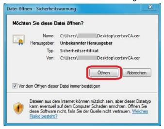
Öffnen Sie diese Datei und installieren Sie das Zertifikat...
